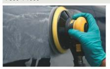
Microstar uniforma la struttura del gel coat e prepara la superficie per una finitura estremamente lucida.
