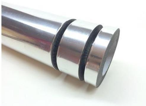
Nastro adesivo in alluminio con adesivo acrilico su supporto di carta mono siliconata, spessore 50 my. Elevata adesività iniziale e fissaggio permanente, buona resistenza alle temperature, all'invecchiamento, all'acqua al fuoco. Ideale per fissaggi e giunte di tubi ed isolamenti per tenuta vapore e muffe. Particolarmente indicato per l'industria del freddo nella produzione di frigoriferi. Viene sezionato su specifica richiesta del cliente.
