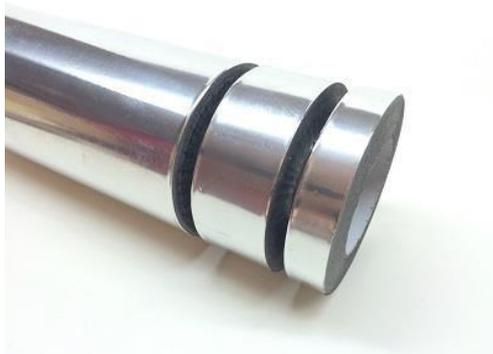
Nastro adesivo in alluminio con adesivo acrilico su supporto di carta mono siliconata, spessore 90 my. Elevata adesività iniziale e fissaggio permanente, buona resistenza alle temperature, all'invecchiamento, all'acqua al fuoco. Ideale per fissaggi e giunte di tubi ed isolamenti per tenuta vapore e muffe. Particolarmente indicato per l'industria del freddo nella produzione di frigoriferi. Viene sezionato su specifica richiesta del cliente.
