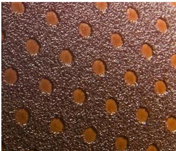
Abrasivo Ultimax con minerale in ossido di alluminio cosparsione aperta legante resina su resina su supporto di carta antistatica F (250/300 g/m<sup>2</sup>). E' prodotto con l'innovativa tecnologia Mirka "Selective Coating™", che crea centinaia di cavità perfettamente rotonde sulla superficie abrasiva.
