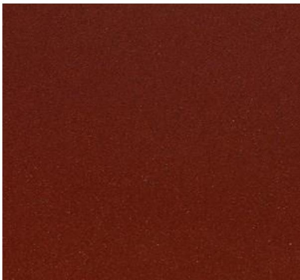
Carta abrasiva Jepuflex con abrasivo in ossido di alluminio, cosparsione chiusa, legante resina su resina, su supporto in carta antistatica tipo F (superiore ai 225 gr/mq.) Il supporto particolarmente pesante e rigido è consigliato per operazioni che richiedono elevate asportazioni e per la produzione di nastri che vengono sottoposti ad elevate sollecitazioni e carichi di lavoro pesanti.
