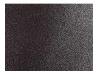
Tela K15F con granulo in ossido di alluminio, legante resina su resina su supporto di tela di cotone JF particolarmente sottile e flessibile. Questa caratteristica permette operazioni di carteggiatura manuale su superfici sagomate o tornite.
