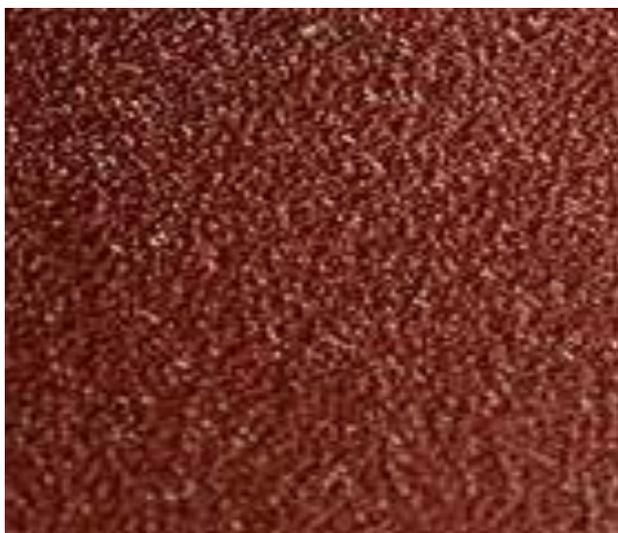
Carta abrasiva K 117 con minerale in ossido di alluminio, cosparsione aperta, legante in resina su supporto di carta antistatica tipo F (250/300 g/m<sup>2</sup>). Supporto molto resistente adatto alla realizzazione di nastri e nastri per la levigatura e calibratura di legni grezzi.
